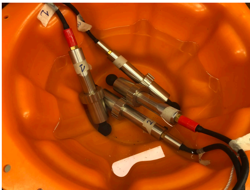
Φωτο. 5: Έλεγχος λειτουργίας των υδροφώνων στο εργαστήριο
