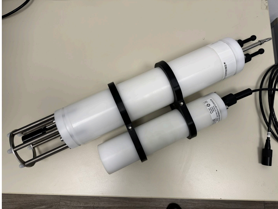
Φωτο. 3: Η στήλη CTD και η εξωτερική μονάδα τροφοδοσίας
