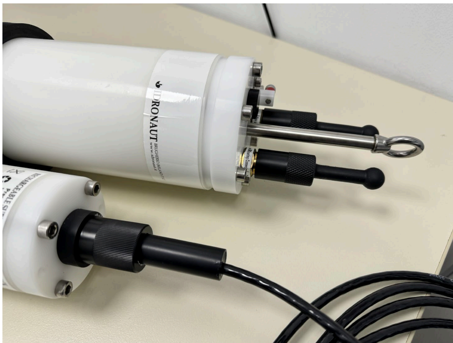
Φωτο. 5: Η πάνω πλευρά της στήλης με τους συνδετήρες (connectors) για την τροφοδοσία και τη σύνδεση με τον Η/Υ
