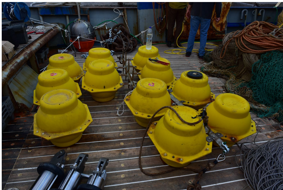
Φωτο 4 Οι πλωτήρες άνωσης
